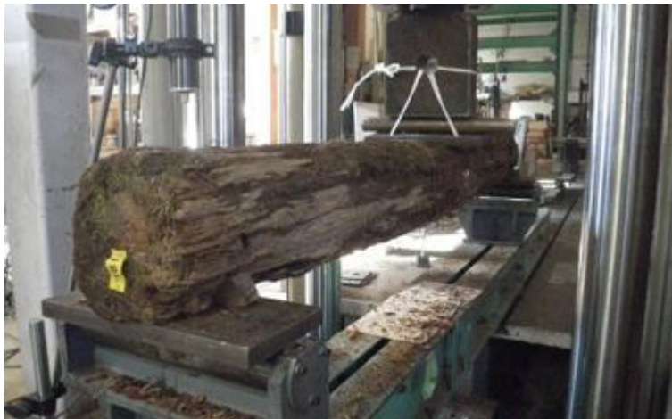
写真2 曲げ試験の様子
