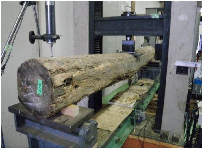
写真2 曲げ試験の様子
