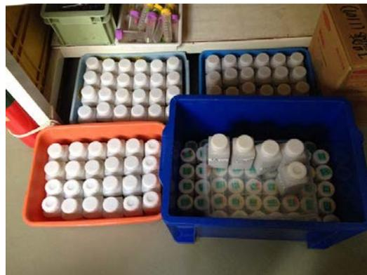
図 風乾・篩別により作製した土壌試料
