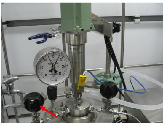
攪拌を止め、(温度を下げ) 電源を落とし、
