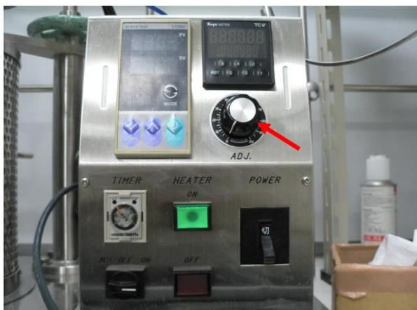
⑭本体右下のスイッチを入にし、左下の黒のレバーを右に倒すと攪拌可能な状態となる。丸いつまみを右に回すことで攪拌する。
